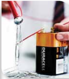
Мал. 45. Саморобний електромагніт
