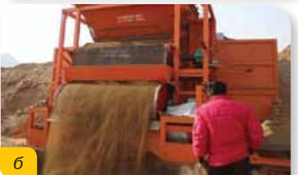
Мал. 44. Магнітний сепаратор: а — схематичне зображення; б — зовнішній вигляд
