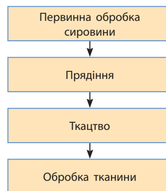
Мал. 2. Стадії текстильного виробництва.
