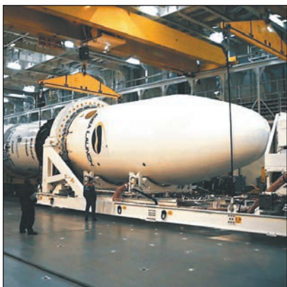
Мал. 4. Складання на підприємстві «Південмаш» ракетного носія «Зеніт» — одного з кращів у світі.
