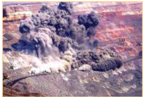
Мал. 60. Підрив ґрунту в Криворізькому кар'єрі
