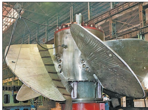
Мал. 2. Турбіна Кременчуцької ГЕС, вироблена на українському заводі «Турбоатом» (місто Харків).
