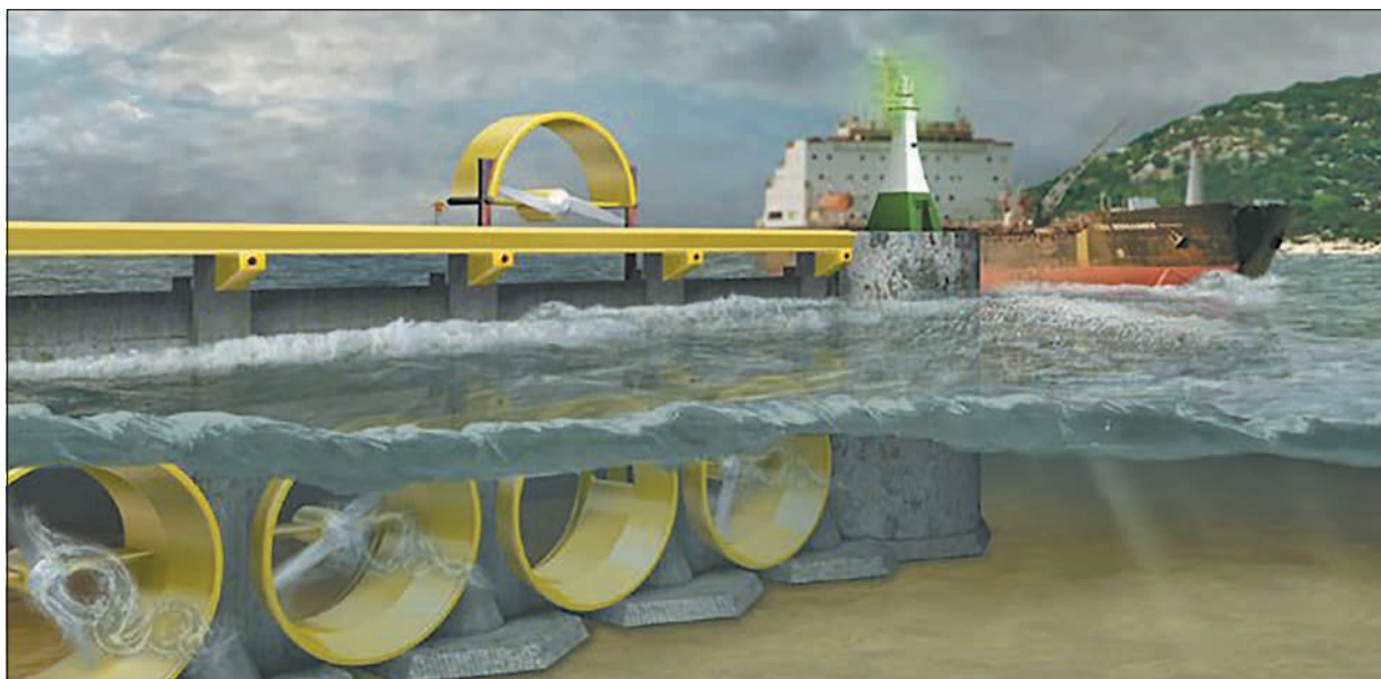
Мал. 3. Принцип роботи припливної електростанції.
