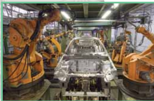
Мал. 142. Промисловий робот KUKA на автомобільному виробництві
