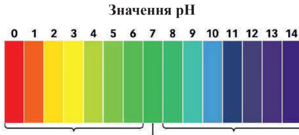
Рис. 11.2. Приклад еталонної кольорової шкали універсального індикатора
