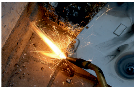
Рис. 27.4. Різання металу з використанням ацетиленового пальника
