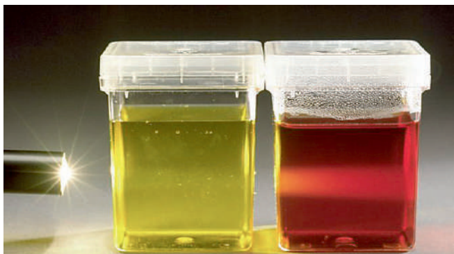
Рис. 3.2. Проходження світла через істинний (зліва) та колоїдний розчини
