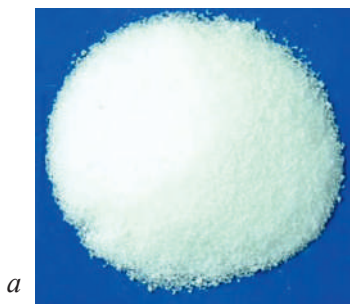
Рис. 7.3. Видалення кристалізаційної води під час прожарювання: а) алюмокалієвих галунів \text{KAl}(\text{SO}_4)_2 \cdot 12\text{H}_2\text{O} : сіль за умов випаровування води спучується; б) мідного купоросу (безперервно поміщуючи, щоб не перегріти і щоб сіль не розклалась до купрум(II) оксиду)
