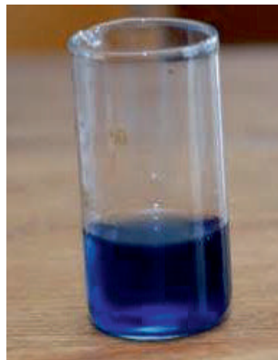
Рис. 38.2. Забарвлення розчину крохмалю після додавання розчину йоду
