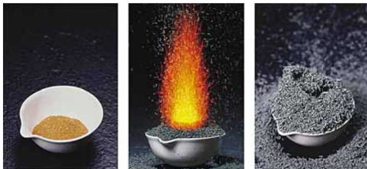
Рис. 17.4. Термічне розкладання амоній дихромату
