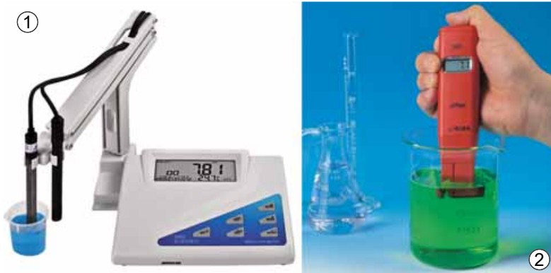
Рис. 14.2. рН-метри. 1. Стационарний. 2. Портативний
