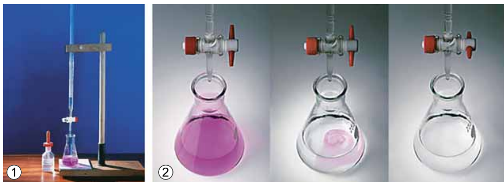
Рис. 15.3. Добавляння краплями розбавленої нітратної кислоти (1) до підфарбованого фенолфталеїном розчину натрій гідроксиду (2)
