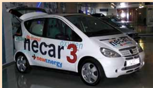
Рис. 33.1. Автомобіль Mercedes Benz Nascar-3 із силовою установкою на прямому метанольному паливному елементі. 2006 рік
