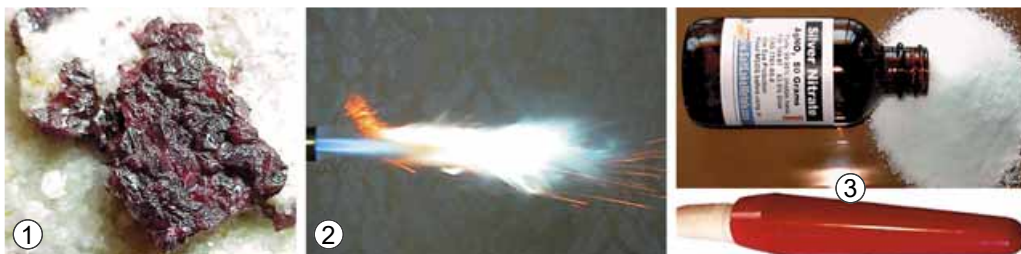
Рис. 1.5. 1. Кіновар, або цинобра, – мінерал класу простих сульфідів, – основа однієї з найдревніших мінеральних фарб. Головний складник – меркурій(II) сульфід. 2. Філософська вовна – так у давнину в алхімічній спільноті називали білий клоччастий цинк оксид – продукт згоряння цинку. 3. Аргентум(I) нітрат – активна речовина ляписного олівця, пригнічує життєдіяльність мікроорганізмів, перешкоджає розвитку запальних процесів у пошкоджених тканинах
