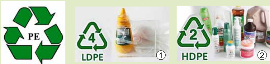
Рис. 29.3. Міжнародне маркування поліетиленових виробів. 1. LDPE (ПЕНТ) – поліетилен низького тиску. 2. HDPE (ПЕВТ) – поліетилен високого тиску
