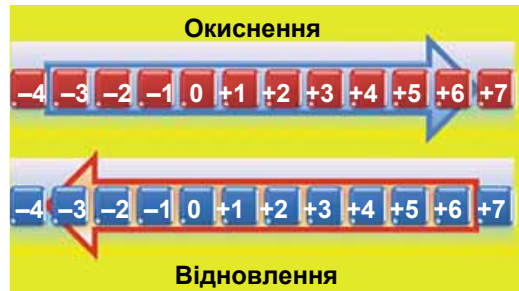
Рис. 18.2. Зміна ступенів окиснення внаслідок окиснення відновника та відновлення окисника
