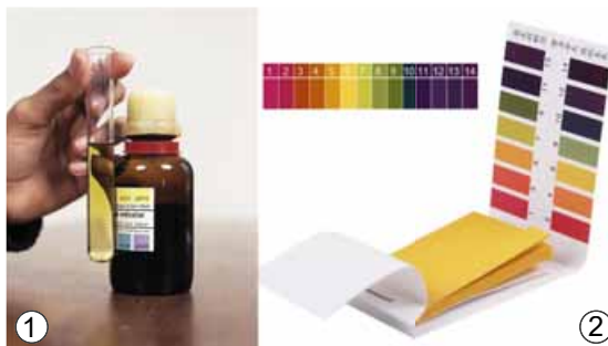
Рис. 14.1. 1. Розчин універсального індикатора. 2. Універсальний індикаторний папір
