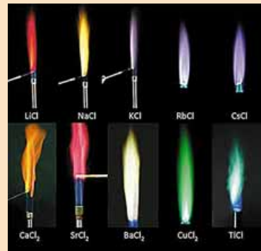
Рис. 16.3. Забарвлення полум'я хлоридами металічних елементів
