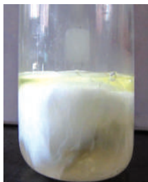
Рис. 120. Осадження білка етановою кислотою
