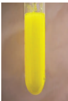
Рис. 43. Якісна реакція на ортофосфат-іон
