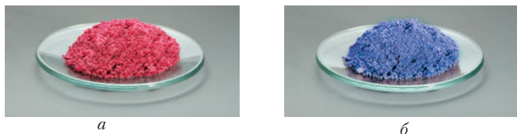
Рис. 26. Кобальт(II) хлорид гексагідрат ( а ) і безводна сіль кобальт(II) хлорид ( б )
