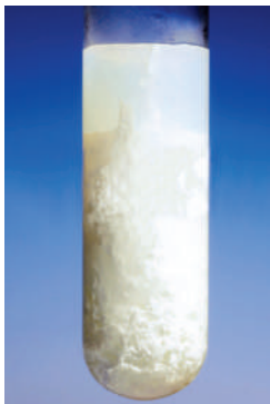
Рис. 39. Якісна реакція на хлорид-іон
