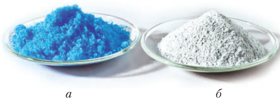
Рис. 25. Купрум(II) сульфат пентагідрат (а) і безводна сіль купрум(II) сульфат (б)
