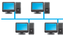
Рис. 3. Топологія «загальна шина»
