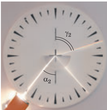
Fig. 12.5. Dacă lumina cade din sticlă în aer, în cazul măririi unghiului de incidență unghiul de refracție se apropie de 90^\circ , iar strălucirea ei scade
