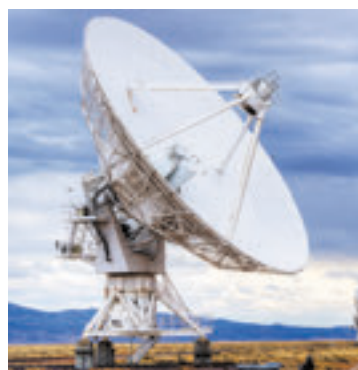
Fig. 21.3. Radiația fascicului direcționat îngust de radiunde ultracurte și receptarea semnalului reflectat este asigurată de antena parabolică a radiolocatorului
