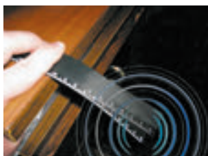
Fig. 18.1. După ce capătului riglei i se va da drumul, rigla va începe să oscileze și să emită sunet
