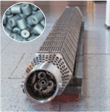
Fig. 27.1. EExTc (element exotermic) – o parte a reactorului, dispozitiv, în care se conține combustibilul nuclear (pastile de dioxid de Uraniu)
