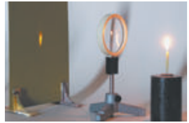
Fig. 15.1. Obținerea imaginii flăcării unei lumânări cu ajutorul lentilei convergente
