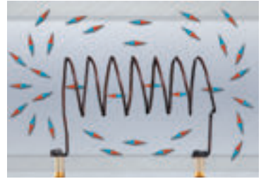
Fig. 3.4. Cercetarea câmpului magnetic produs de o bobină parcursă de curent cu ajutorul acelor magnetice
