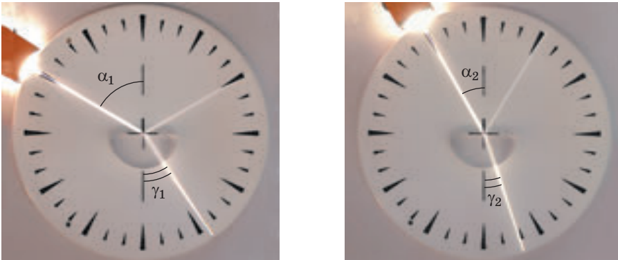
Fig. 12.3. Stabilirea legilor refracției luminii: în cazul micșorării unghiului de incidență ( \alpha_2 < \alpha_1 ) unghiul de refracție de asemenea se micșorează ( \gamma_2 < \gamma_1 ) totodată \frac{\sin \alpha_1}{\sin \gamma_1} = \frac{\sin \alpha_2}{\sin \gamma_2}
