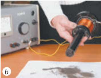
Fig. 6.4. După închiderea circuitului pilitura de fier este atrasă de meiz (a); după deschidere – cad (b)
