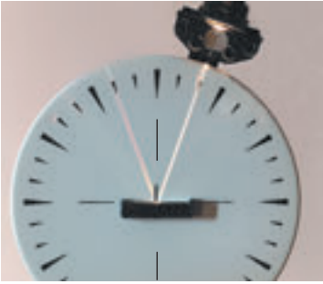
Fig. 11.3. Odată cu schimbarea unghiului de incidență variază și unghiul de reflexie. Unghiul de incidență de fiecare dată este egal cu unghiul de reflexie
