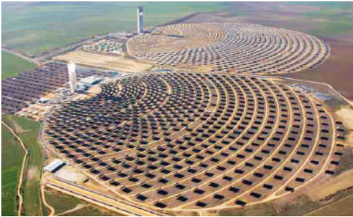
Des. 189. Turnuri solare pentru a genera electricitate aproape de orașul Sevilla (Spania)
