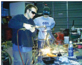
Fig. 67. Tăierea metalului cu ajutorul lămpii cu acetilenă
