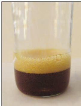
Fig. 37. Descompunerea peroxidului de hidrogen în prezența clorurii de fier(III)
