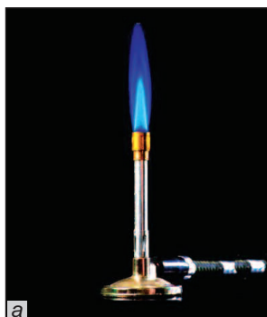
Fig. 52. Arderea metanului: a — în becul de gaz; b — în plita de bucătărie
