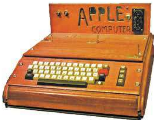
Rys. 1.9. Pierwszy komputer Apple nie posiadał jeszcze własnego monitora i był podłączony do telewizora domowego
