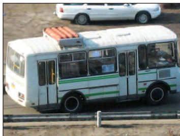
Fig. 64. Autocar, motorul căruia funcționează pe gaz natural
