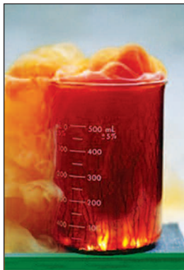
Fig. 28. Reacția aluminului cu borul
