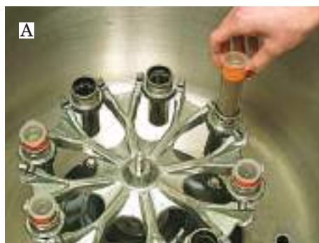
42. ábra. A. Centrifuga. B. A centrifugálás módszere: a sejt struktúrák tömegfüggő ülepedésének egymást követő stádiumai
