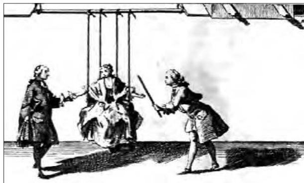
40.6. ábra. A vezetők és szigetelők létezésének igazolása (XVIII. századi metszet). A képen selyemszálakon függő hintában egy nő ül. A jobb oldalon álló férfi egy feltöltött rudat közelít a nő kezéhez. A másik oldalon lévő férfi a kezét nyújtja a nő másik kezéhez, eközben közöttük szikra jön létre
