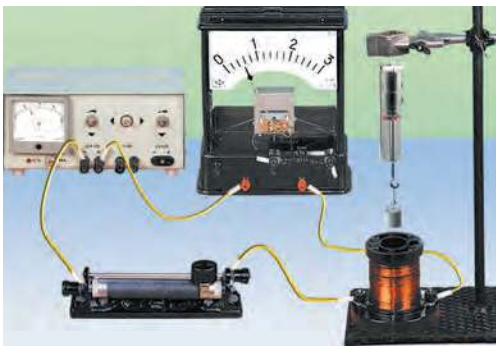
6.1. ábra. Az áramjárta tekercs mágneses hatásának vizsgálata
