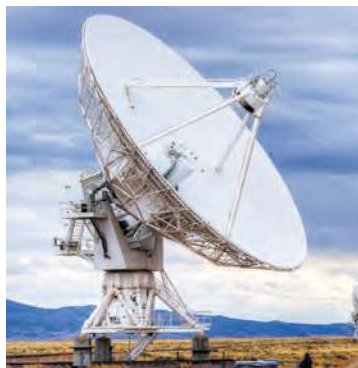
21.3. ábra. Az ultrarövid rádióhullámok keskeny irányított nyalábjának a sugárzását és a visszaverődött jel felfogását a radar parabola-antennája végzi
