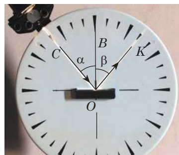
11.2. ábra. A fényvisszaverődési törvény bemutatása optikai korong segítségével: \alpha – beesési szög; \beta – visszaverődési szög
