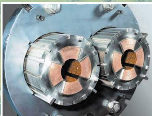
2. ábra. A töltött részecskét a gyorsító belsejében tartó szupererős mágnesek
