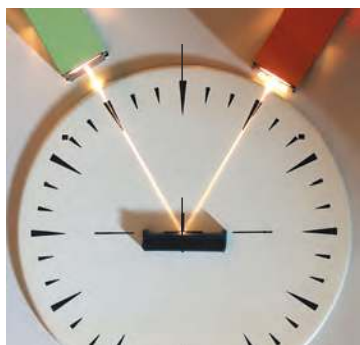
11.5. ábra. A fénysugarak megfordíthatóságának bemutatása: a visszavert sugár a beeső sugár vonalán halad
