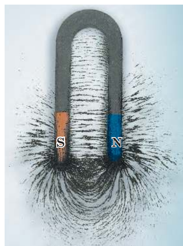
2.4. ábra. A vasreszelék által alkotott kép megmutatja a mágnespatkó mágneses terének indukcióvonalait
