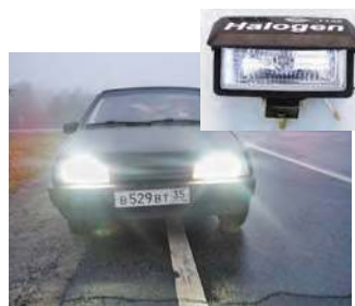
9.2. ábra. A nagy teljesítményű mesterséges fényforrás egyik példája a modern gépkocsik fényszórójában használt halogén izzó
