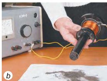
6.4. ábra. Az áramkör zárása után a vasmag magához vonzza a vasreszeléket (a); megszakításakor a vasreszelék lehullik (b)
