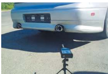
5. ábra. Gépkocsi zajszintjének mérése
