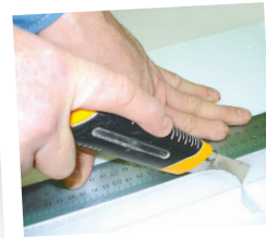
Різання листового пінопласту шпалерним ножем
