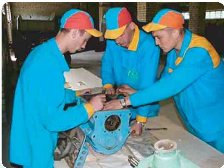
Мал. 122. Складання коробки передач транспортного засобу
