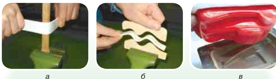
Мал. 105. Прийоми надання бажаної форми листовим термопластичним пластмасам: а — на розігрітому металевому стрижні; б — за допомогою оправки на дерев'яному шаблоні; в — у матриці за допомогою пуансона
