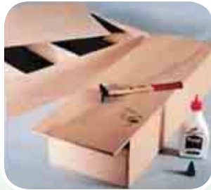
Мал. 201. Закріплення стінок: а — задньої; б — передньої
