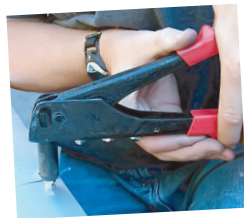
Прийоми роботи ручним заклепочником
