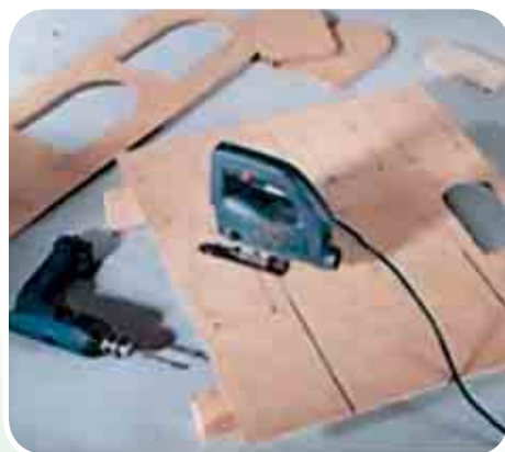
Мал. 199. Випилювання деталей електролобзиком
