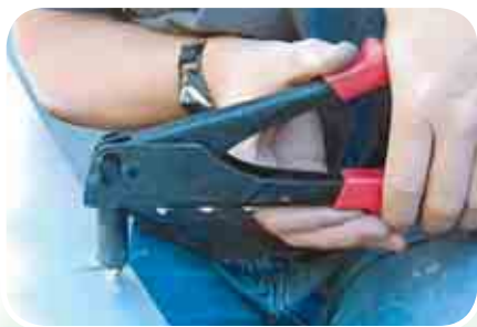
Мал. 88. Використання заклепкового пістолета: а — прийоми роботи ручним заклепковим пістолетом; б — зовнішній вигляд трубчастих заклепок
