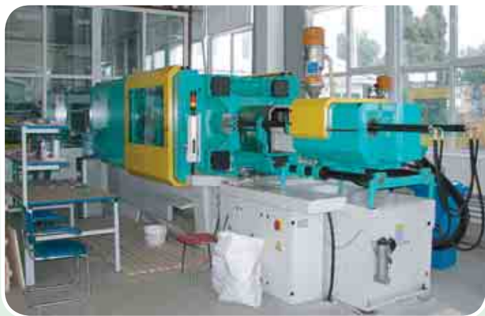
Мал. 135. Робоче місце ливарника пластмас
