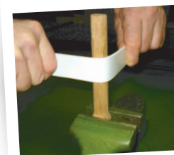
За допомогою оправки на дерев'яному шаблоні
