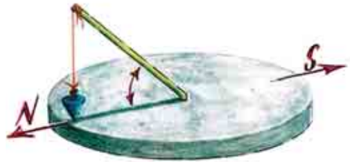
Мал. 214. Розмічання «годинникового циферблата»: а — нанесення поділок; б — визначення сторін світу
