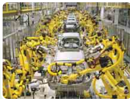
Мал. 140. Автоматична лінія збирання кузовів автомобілів
