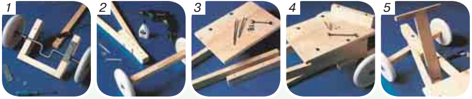
Мал. 207. Етапи виготовлення комплексного виробу «Чотириколісний самокат»
