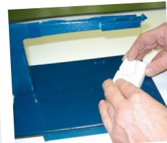
Різання пінопластової заготовки пристроєм для різання за допомогою нагрітого дроту
