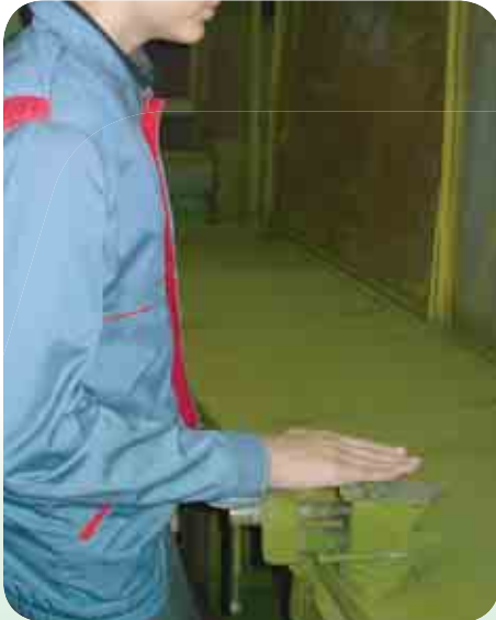
Мал. 10. Перевірка правильності вибору висоти робочого місця, обладнаного слюсарними лецатами
