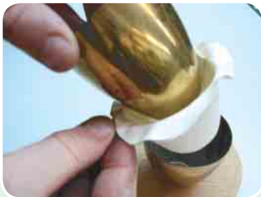
Мал. 107. Пуансон та спрощена матриця для формування з листового термопластичного матеріалу тіла еліпсоїдної форми
