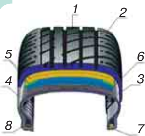
Мал. 4. Будова безкамерної шини: 1 — протектор із гуми; 2 — плече покришки; 3 — капроновий корд; 4 — захисна бічна смуга з жорсткої гуми; 5 — брекер зі сталевого корду; 6 — протекторне кільце з гуми; 7 — силове кільце з металкорду; 8 — борт для встановлення
