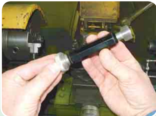
Мал. 132. Приклад використання різьбової пробки типу «прохід—непрохід»
