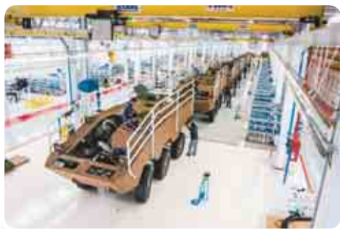
Мал. 139. Автоматизована лінія збирання бронетранспортерів на заводі Iveco
