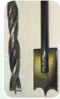
Мал. 79. Свердла для свердління пластмас: а — спіральне свердло; б — плоске свердло (перове)
