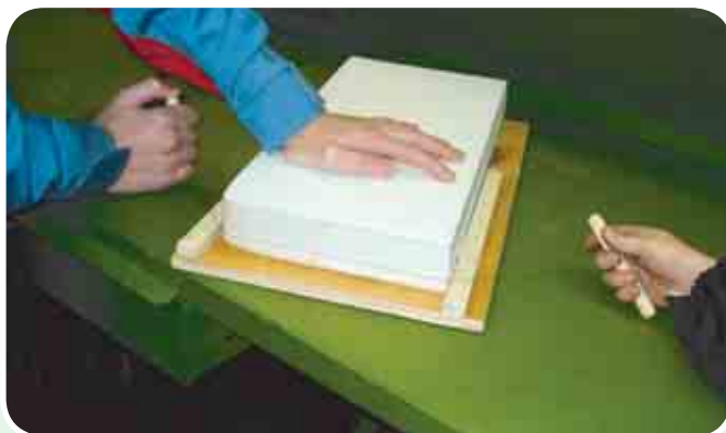
Мал. 75. Різання пінопластової заготовки за допомогою сталевого дроту (без нагрівання)
