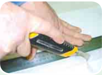
Мал. 82. Різання листового пінопласту шпалерним ножом
