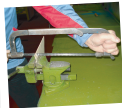
Різання пінопластової заготовки за допомогою сталевого дроту
