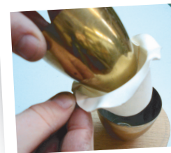
Формування тіла еліпсоїдної форми за допомогою пуансона та спрощеної матриці
