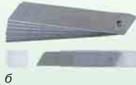
Мал. 73. Ніж для різання рулонних матеріалів (шпалерний ніж): а — загальний вигляд; б — змінні леза
