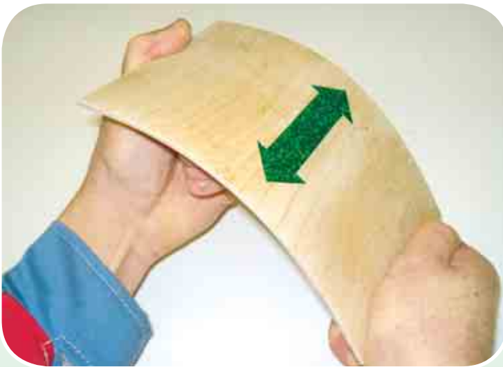
Мал. 97. Напрямок волокон у зовнішніх шарах фанери при її згинанні має відповідати напрямку стрілки
