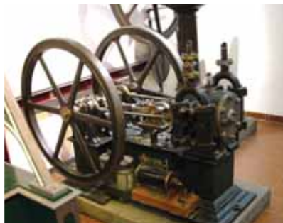
Двигун внутрішнього згоряння Етьєна Ленуара (Франція, 1860 р.)
