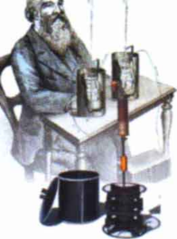
Установка Джоуля для визначення механічного еквіваленту теплоти
