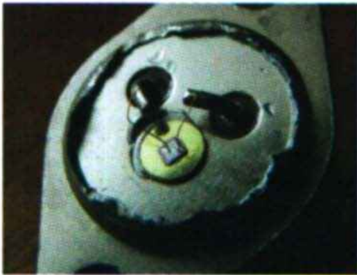
Мал. 1. Кремнієва пластинка всередині напівпровідникового транзистора
