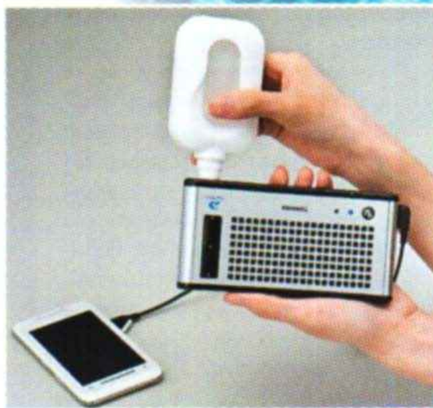
Метаноловий паливний елемент. Заправивши його кількома ложками спирту, можна двічі зарядити мобільний телефон
